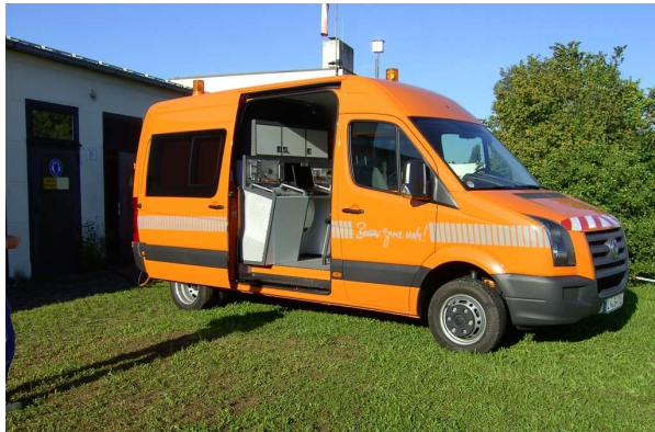
Kabelprüfung mit Messwagen
